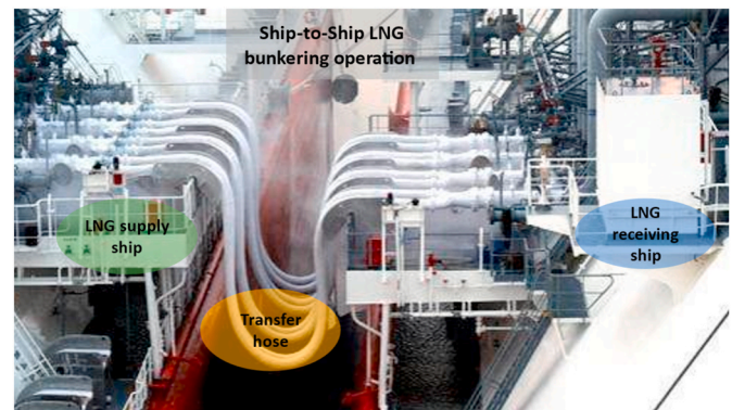
Fig. 4. Ship-to-Ship LNG bunkering operation(KLAW, 2022).
