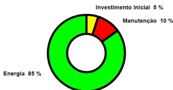
Fig. 2.8 – Custos típicos associados a um sistema de bombagem ao longo da sua vida útil.
