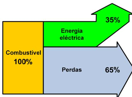
Fig. 2.15 – Rendimento típico de uma unidade convencional de geração de energia eléctrica.
