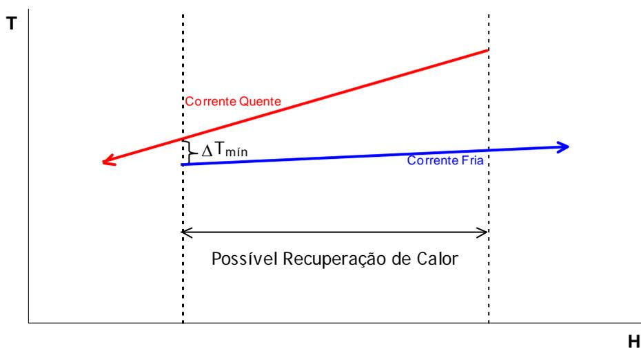
Fig. 2.24 – Exemplificação do  $\Delta T_{\min}$
