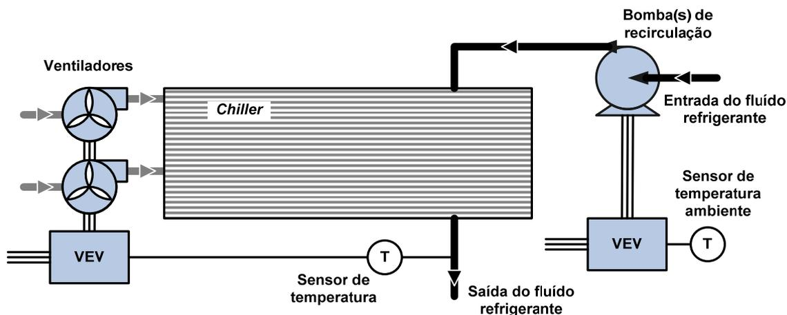
Fig. 2.13 – Exemplo da aplicação de VEVs a um sistema de ventilação: *chiller* com ventiladores e com a bomba de recirculação de fluido refrigerante acoplados a VEVs. Figura adaptada de [25].
