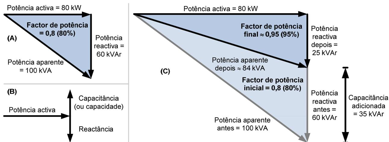
Fig. 2.26 – Definição de potência activa, potência reactiva, potência aparente e factor de potência (A). Efeito da capacitância na potência reactiva (B): diminuição da potência reactiva através da instalação de condensadores (C). Fonte: [36].
