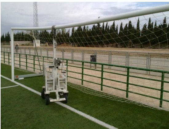
Figura 1. Prueba de resistencia en porterías.
